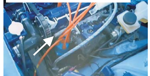
Múltiple de admisión desplazado para instalar 2 carburadores de tiro horizontal en un motor con distribuidor en el bloque. También se eliminó el servo de freno. (Hidrovac)
